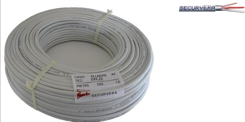
**SM-CS2** Cavo schermato flessibile antifiamma GR2 2XØ0,22 mm<sup>2</sup>. Sistema twistato a coppie, con nastro poliestere, schermo in alluminio 9/12 micron applicato secondo le norme CEI 46/-5. CEI 20-22 III (IEC 60332-3) Filo di drenaggio rame rosso 7 capillari. **Speciale per impianti d'allarme.** Isolamento 1000 Vcc. Dimensioni esterne Ø 3,5 mm. Fornito in matasse da 100 metri, confezionato a macchina, protetto da busta trasparente plastica. Peso matassa 1,280 Kg.
